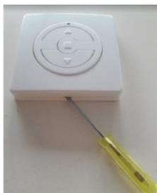
**ETAPE 2 :** Otez le clavier en faisant levier avec un tournevis comme sur les photos ci-dessous.
