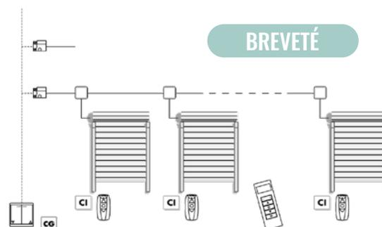
> Commande filaire centralisée permettant de piloter à partir d'un point de commande général un groupe de volets ou de stores équipés de moteurs radio embarqués reliés à une ligne BUS
